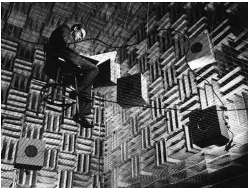
Рис 1 Моделирование параметров помещения в заглушенной камере
