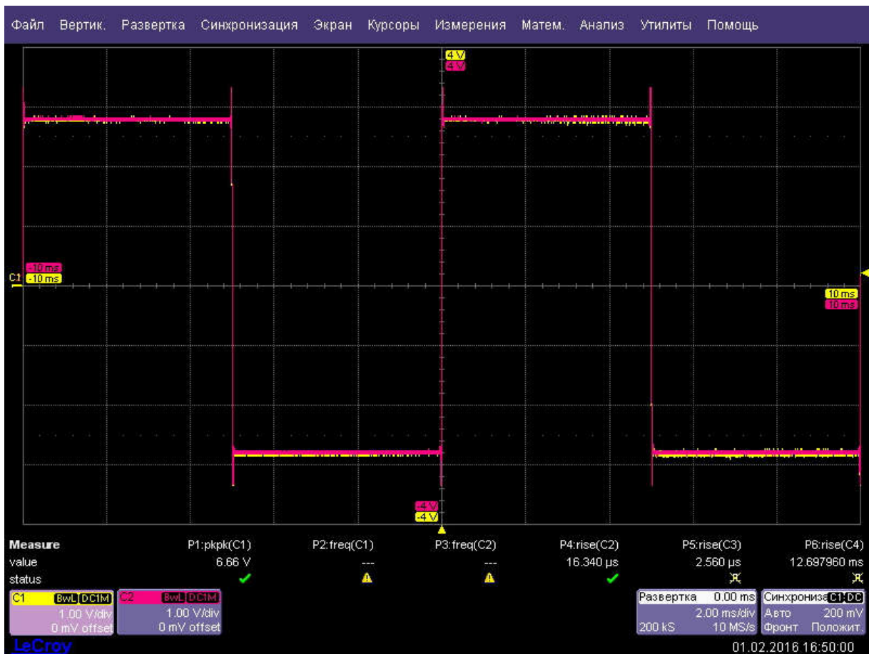
График выходного сигнала прямоугольной формы частотой 100 Гц. Присутствуют выбросы.
