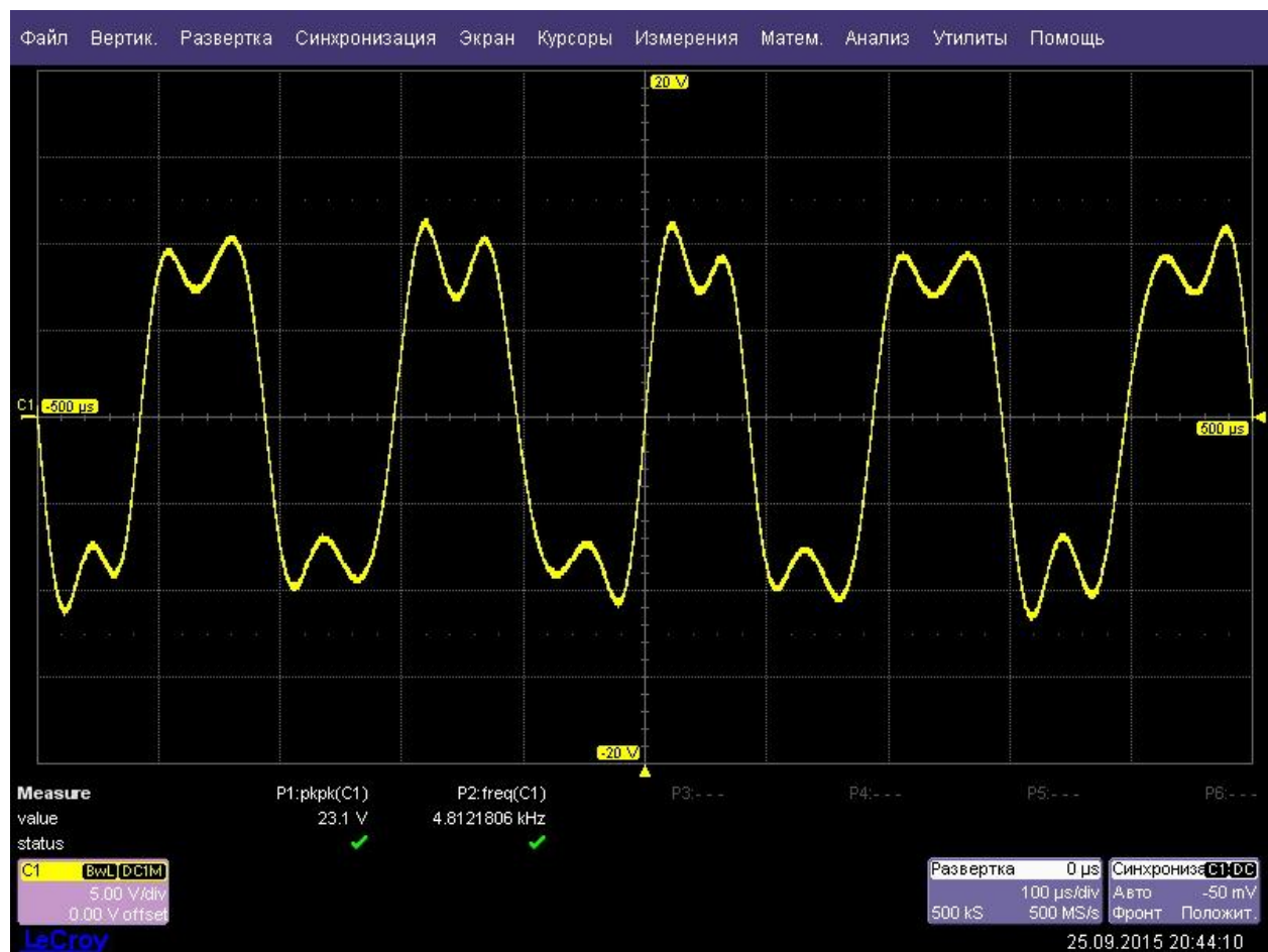
График прямоугольного выходного сигнала частотой 5 кГц.
