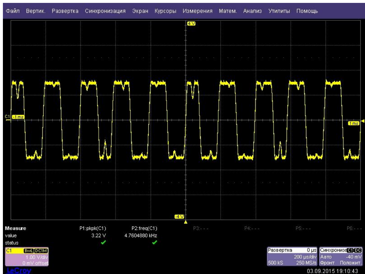
График прямоугольного выходного сигнала частотой 5 кГц.
