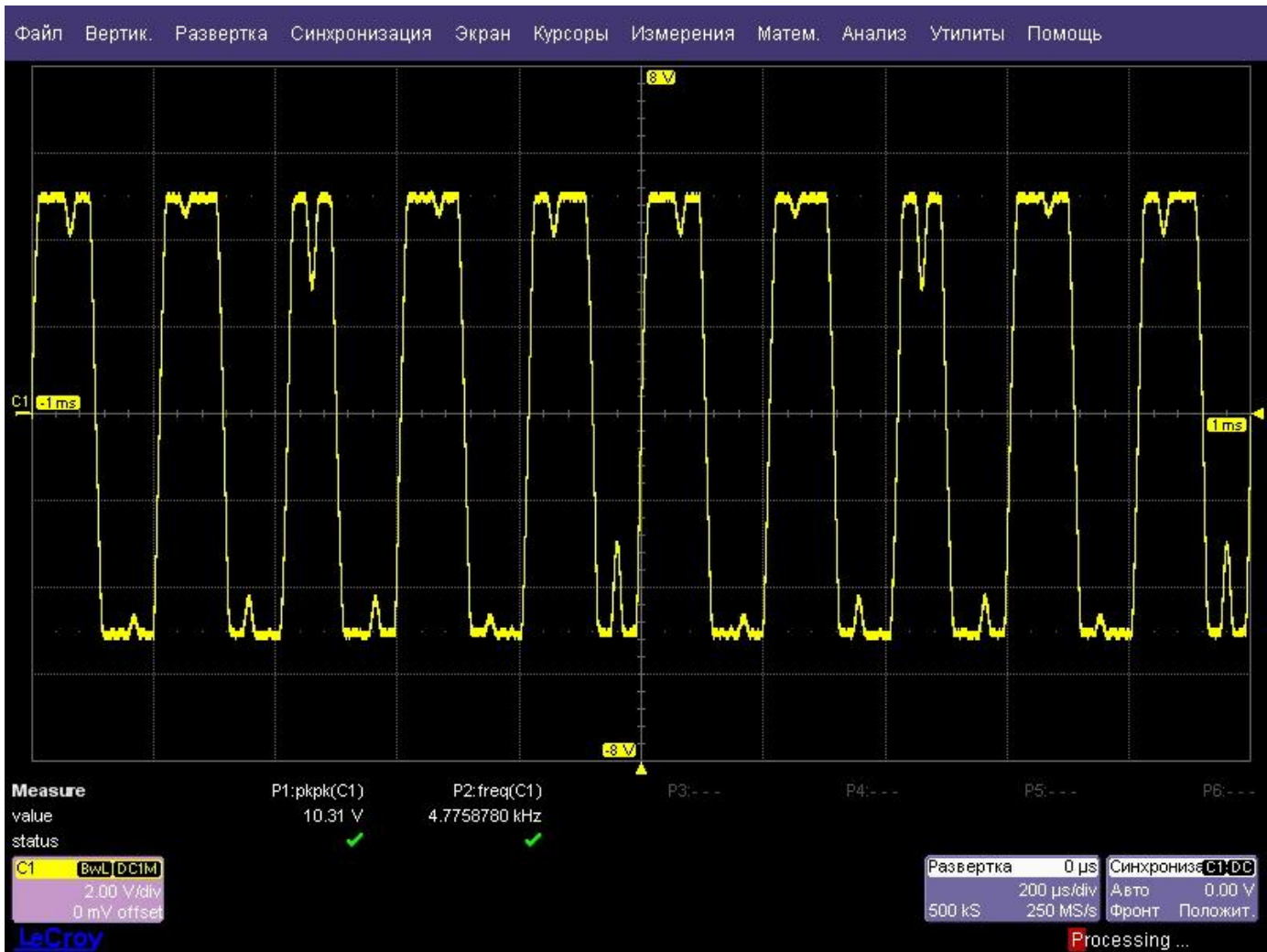
График прямоугольного выходного сигнала частотой 5 кГц.
