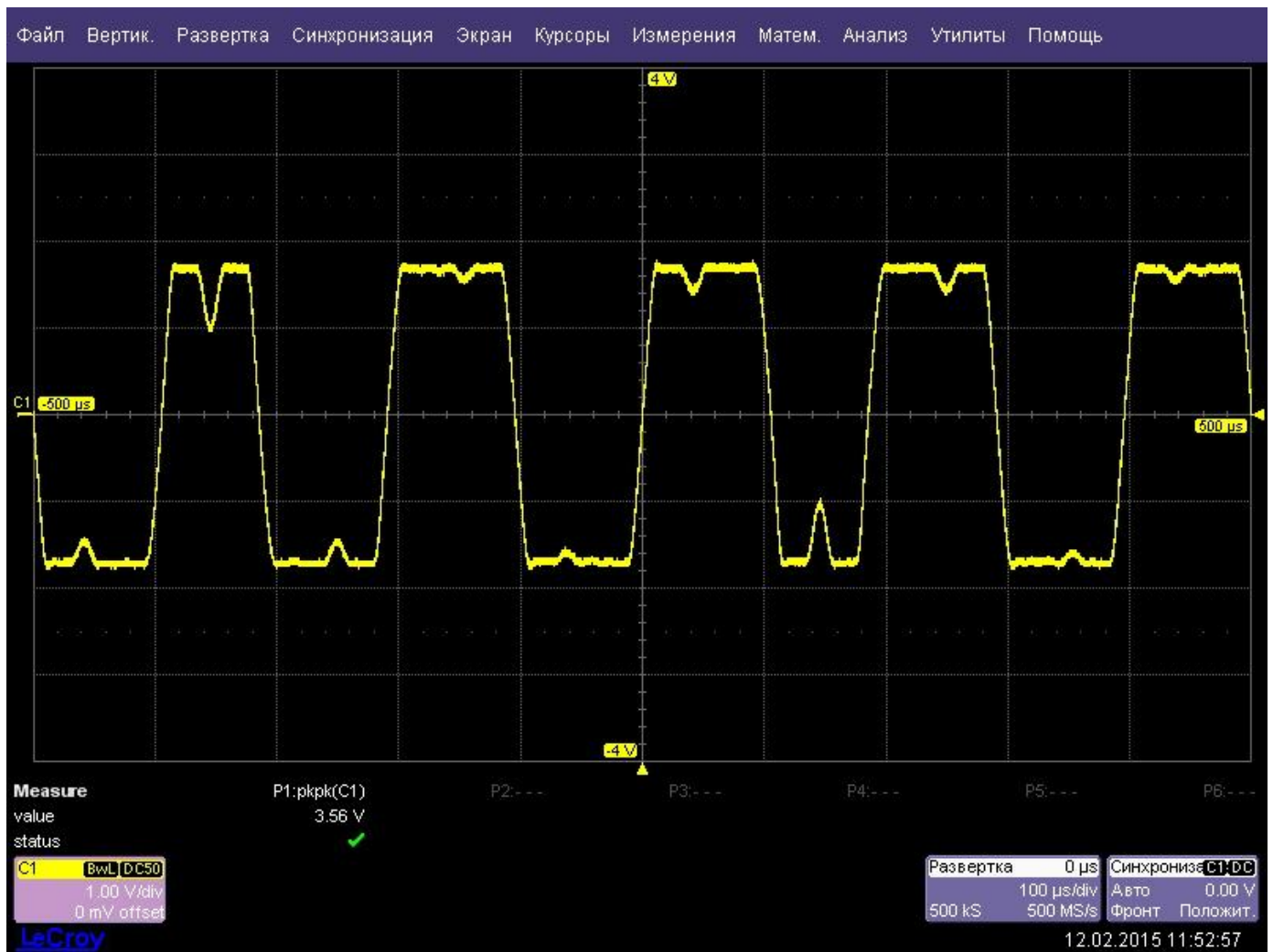
График прямоугольного выходного сигнала частотой 5 кГц.
