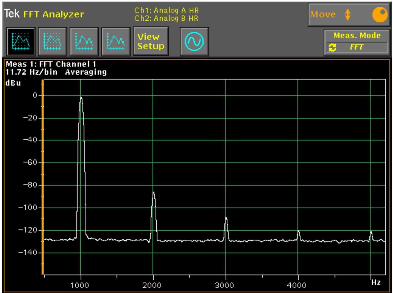
Разность между уровнем сигнала и гармоник составляет примерно 82 дБ. Шумы и прочие спектральные компоненты не превышают уровень -120 дБ.
