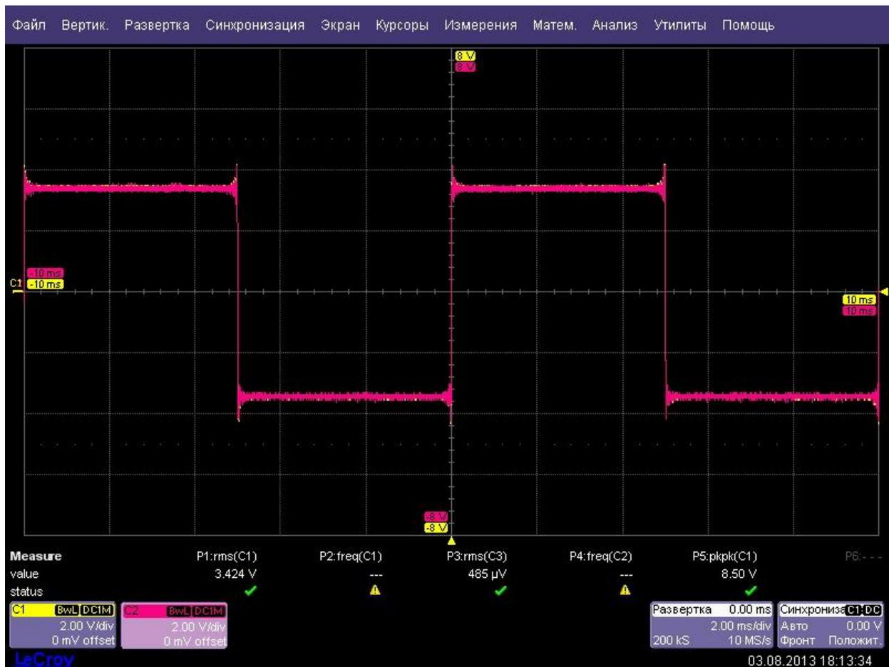
График выходного сигнала прямоугольной формы частотой 100 Гц.
