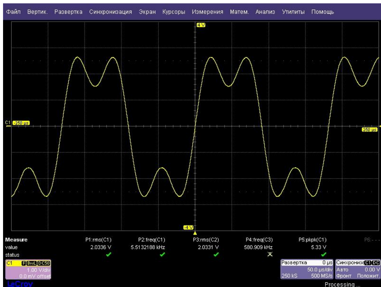
График прямоугольного выходного сигнала частотой 5 кГц.
