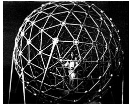
Рис.4 Размещение громкоговорителей на сфере в заглушенной камере
