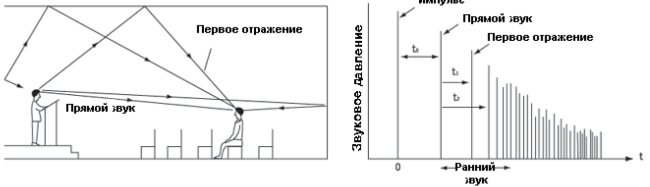
Рис.6 Структура отраженных сигналов в помещении
